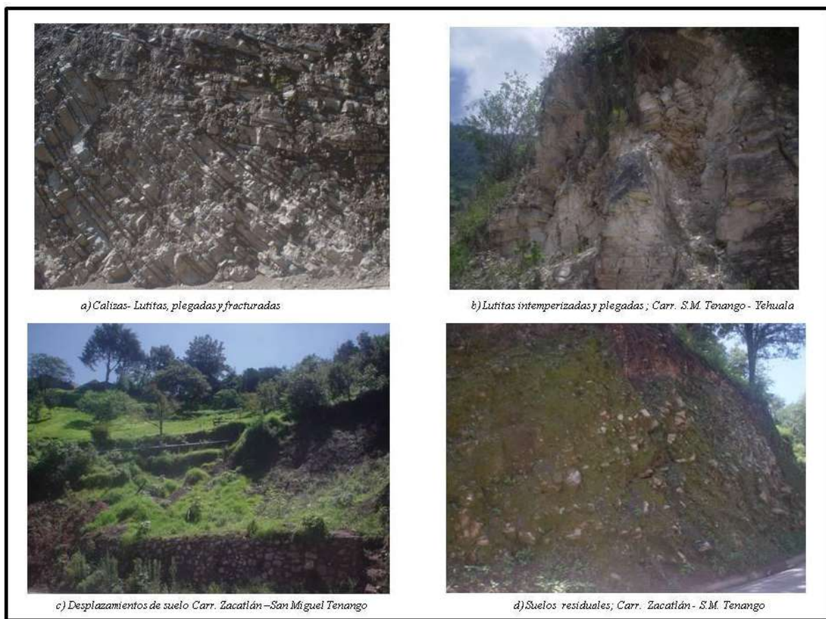
Figura V.16.- Diferentes aspectos de las condiciones geológicas susceptibles a Procesos de Remoción de Masas (Deslizamientos, Derrumbes y Flujos).
